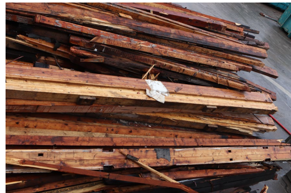
Abbildung 19: Rückgebautes Altholz für die Wiederverwendung als Baugrubensicherung beim Neubau vor Ort (Foto L. Seidl, BFH).
