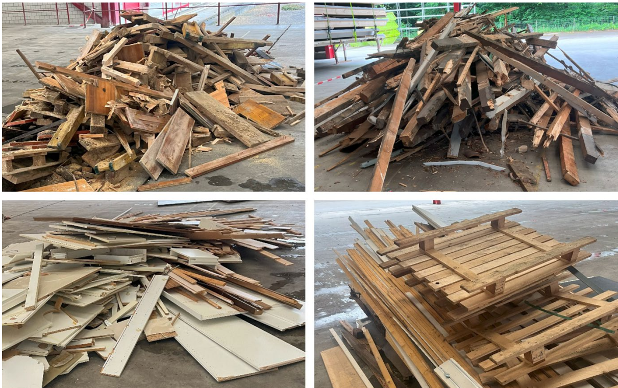
Abbildung 1: Mulde 1: Industrie-Restholz von einer Baustelle (oben links), Mulde 2: Altholz von einem Dachstuhl (oben rechts), Mulde 3/4: Altholz aus dem Innenausbau (unten links und rechts, Bilder J. Steinemann).
